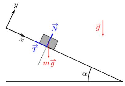
**2 – Mesure de coefficients de frottement statique**
