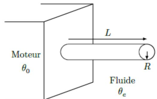
1 - Combien doit-on placer d'ailettes sur le moteur sachant que le flux thermique à évacuer vaut  $\Phi_T = 40 \text{ W}$  ?
