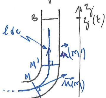
Considérons le tube de courant entre M et M'. Les normales locales aux sections du tube en M et M' sont  $\vec{n}(M)$  et  $\vec{n}(M')$ .
